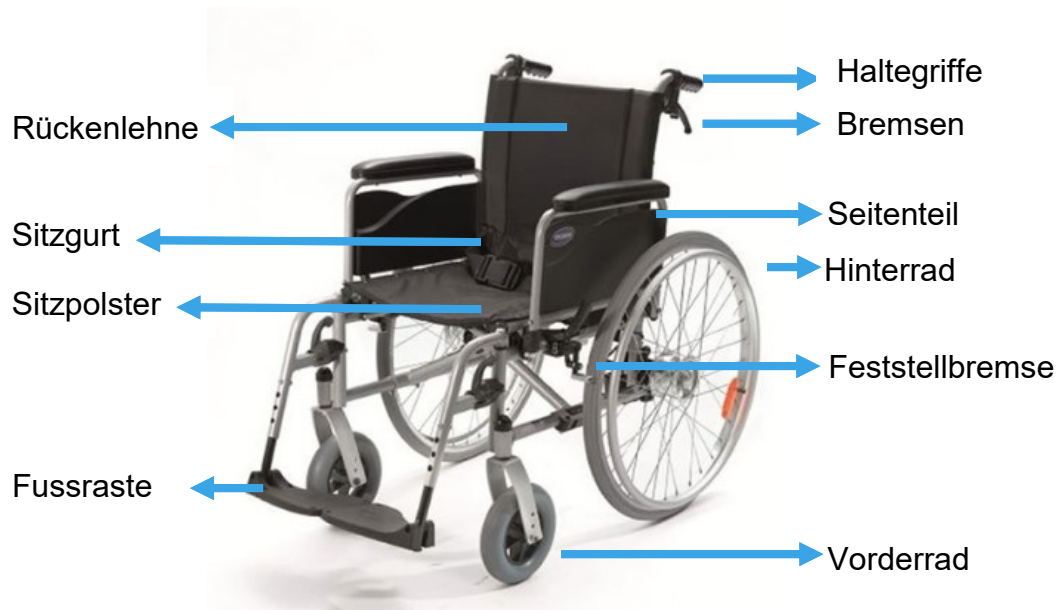
Abb. 1: Ein Rollstuhl und seine Einzelteile.
